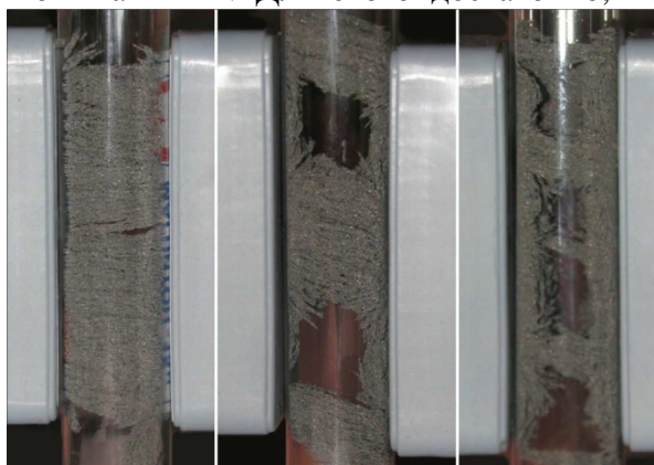
Различная конфигурация магнитного поля внутри прозрачного трубопровода в зависимости от расположения магнитов внутри устройства
